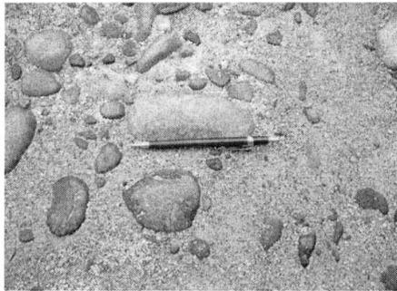
Fotografía N° 1: Se puede establecer que el tamaño del material granular es de aproximadamente de 120 mms, correspondiente al kilómetro 0,930.
